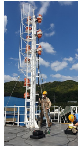
Fig. 11 Impact Hammer Test
